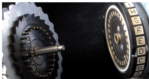
Figuur 1. Een onderdeel van de Enigma Machine: een encryptie/descriptie mechaniek uit de jaren 20.
