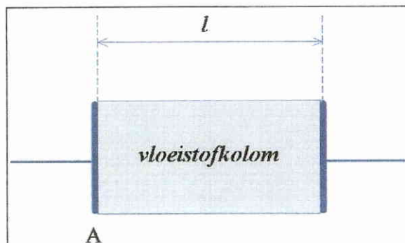
Figuur B.1-2 Schematische voorstelling van de geleidbaarheidscel.
