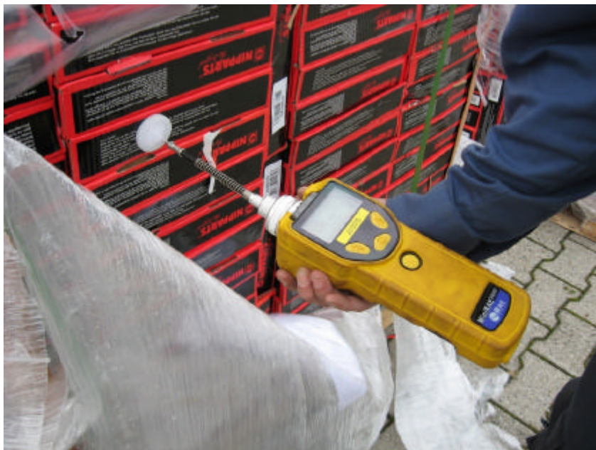
FOTO – 0128 – bijschrift: Meting bij onderzoek naar productgassen in de verpakking.
