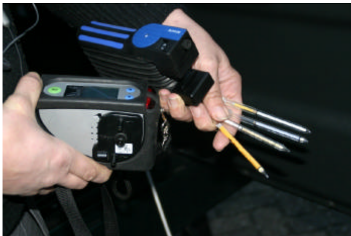
FOTO 5920 - bijschrift: Voor de indicatieve controle meting op de aanwezigheid van gevaarlijke stoffen in de container kan gebruik worden gemaakt van drager buisjes.
