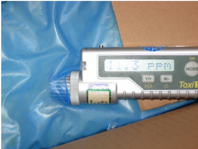
FOTO – 0054 – bijschrift: Meting concentratie methylbromide in de verpakking.
