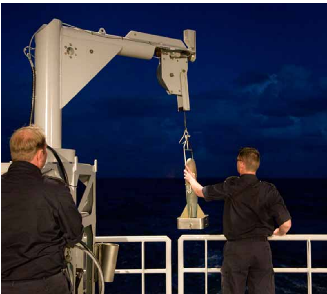
Sonde-meting aan boord van het hydrografisch schip Hr. Ms. Luymes.
