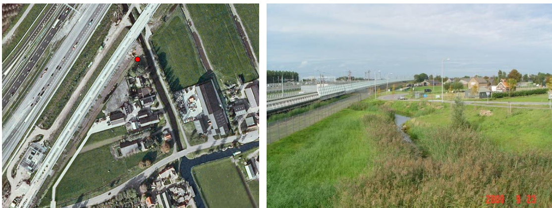
Figuur 2.3: De meetlocatie in Hoogmade. Links is de microfoonpositie (rode punt) op de luchtfoto aangegeven. Op de foto rechts ligt het meetpunt langs het geluidscherm aan de rechterkant, net achter de schuur die in het midden van de foto dicht langs het spoor staat (meethoogte 3,5 meter ten opzichte van het maaiveld).
