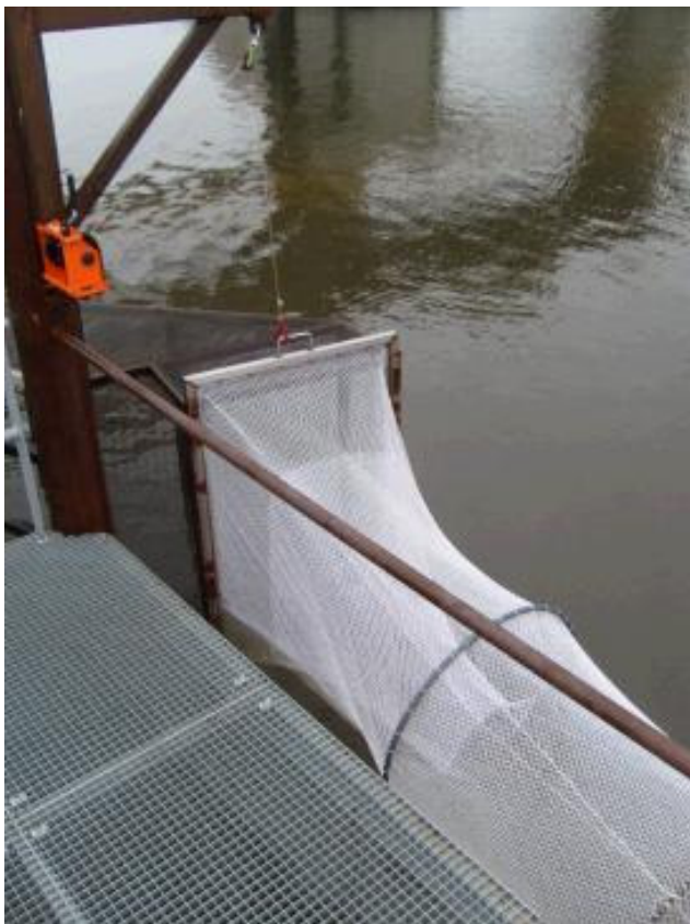
Figuur 8. Zicht van de steiger op de takel met fuikconstructie van de hevelvistrap.
