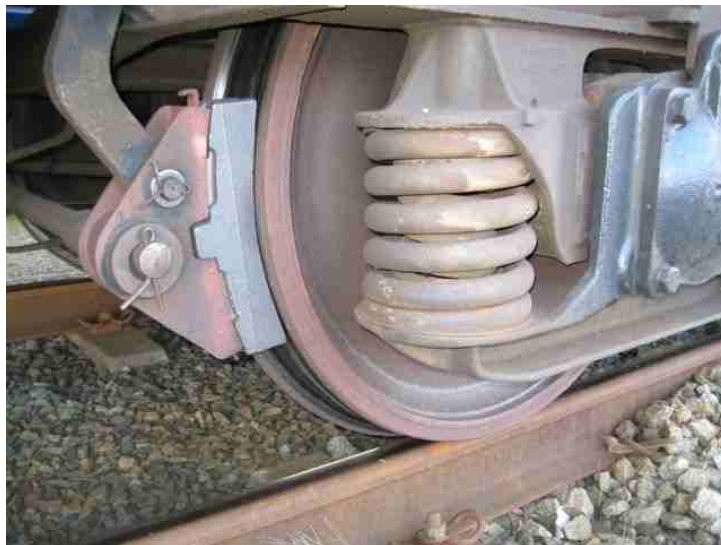
Afbeelding 10: Voorbeeld van blokremmen. De stalen blokken worden direct op de wielen gedrukt. Hierdoor wordt bij het afremmen het wieloppervlak schoon geschraapt en opgeruwd.
