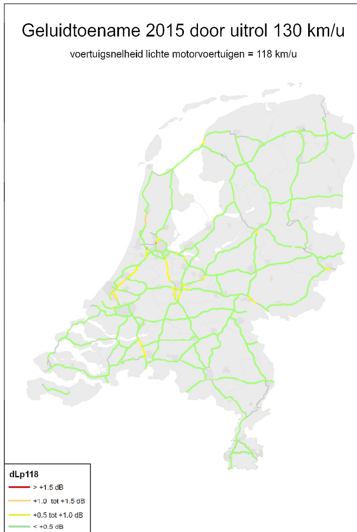
Figuur 5.3: toename geluidsniveaus als in 2015 het basisscenario wordt ingevoerd, zonder mitigerende maatregelen
