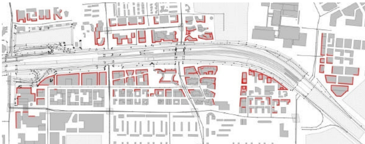
figuur 1.7 Gevels in de referentiesituatie met een belasting van meer dan 53 dB als gevolg van de A10
