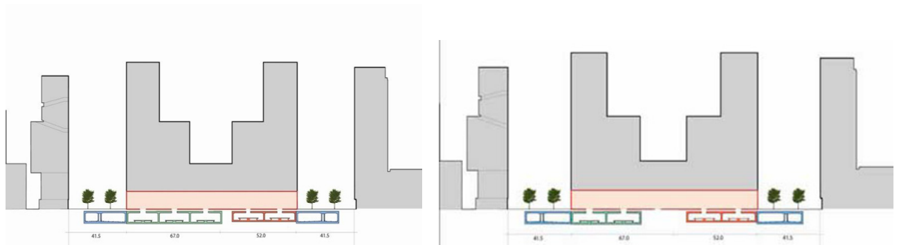
Figuur 11 Schematische weergave van alternatief 1 (links: 6 sporen en rechts: 4 sporen)
