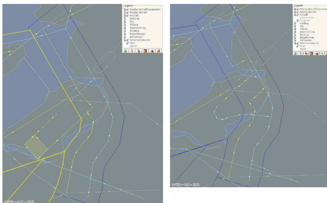
Figuur B. 3: Schetsmatig route- en luchtruimontwerp voor het Delta Scenario voor gebruik Lelystad baan 05 (links) en baan 23 (rechts). (Toelichting: dikke gele lijn: Schiphol TMA,
