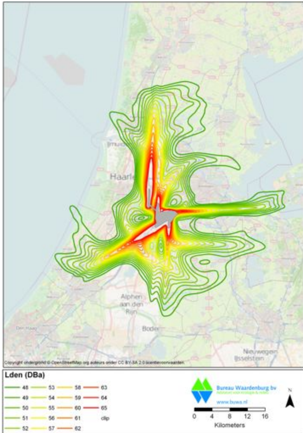
Figuur 2.2a Geluidscontour van vliegverkeer van en naar Schiphol op het vijfbanenstelsel (2008, L_{den} , uitgedrukt in dB(A)) (bron Ministerie van I&M).
