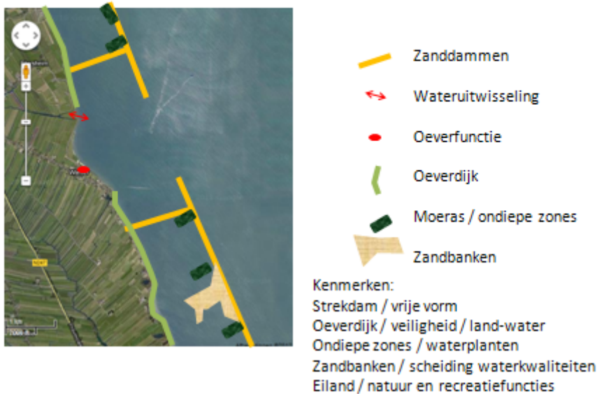
Figuur 3.2 Basisprincipe luwtestructuur
