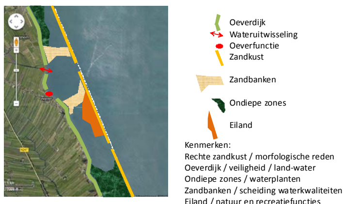
Figuur 3.8 Voorbeeld van invulling van luwtestructuur
