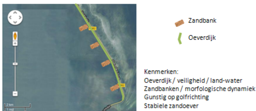
Figuur 3.9 Oeverdijk langs Houtribdijk met extra zandbanken
