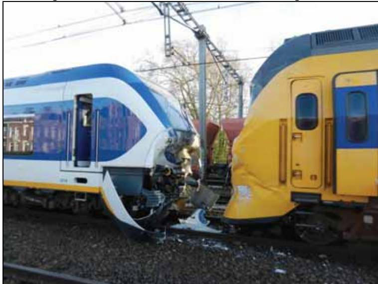
Afbeelding 1: foto van de schade na de frontale botsing
