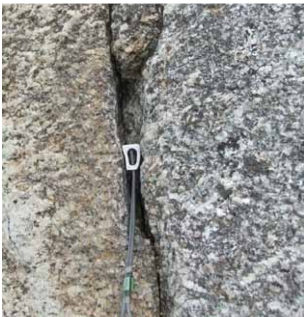
Afbeelding 11b: Detailfoto spleet (in de spleet zit een nut, in het geval van het slachtoffer was dit een Camalot)
