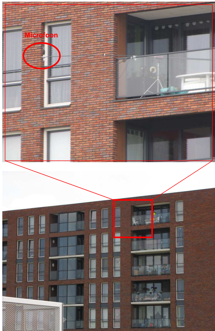
Figuur 6 Microfoon voor gevel van de woning op de 7 e verdieping van de flat aan de Witteveenstraat 201.
