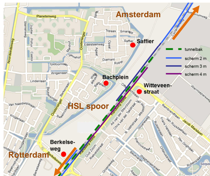
Figuur 11 Overzicht van het HSL spoor in Lansingerland met daarin aangegeven de meetlocaties, de geluidschermen langs het HSL traject en de locatie van de tunnelbak.
