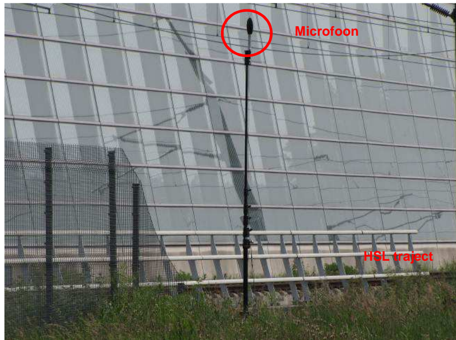
Figuur 12: Een van de microfoons naast het spoor ten behoeve van de snelheidsbepaling, met aan de andere spoorzijde een geluidscherm van 9 meter hoog.
