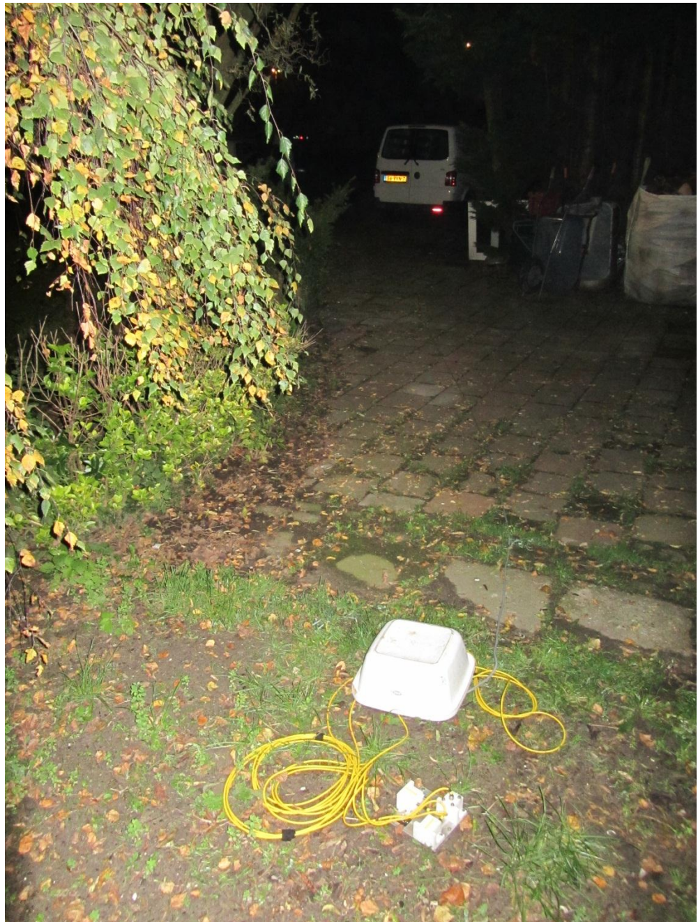
Figuur 31 Foto versnellingsopnemers meetpunt maaiveld 50m vanaf spoor
