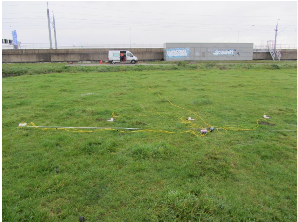
Figuur 40 Foto versnellingsopnemers meetpunt maaiveld 50m vanaf spoor
