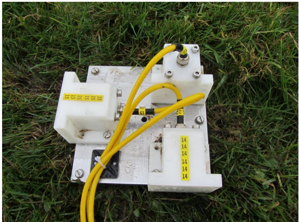
Figuur 41 Foto versnellingsopnemers meetpunt maaiveld 50m vanaf spoor
