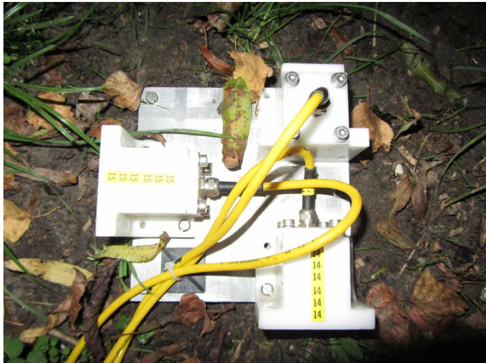
Figuur 32 Foto versnellingsopnemers meetpunt maaiveld 50m vanaf spoor
