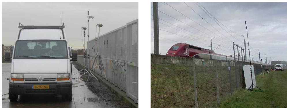
Figuur 9 Snelheidsmeting met radar in Berkel (links) en microfoons in Hoogmade (rechts)
