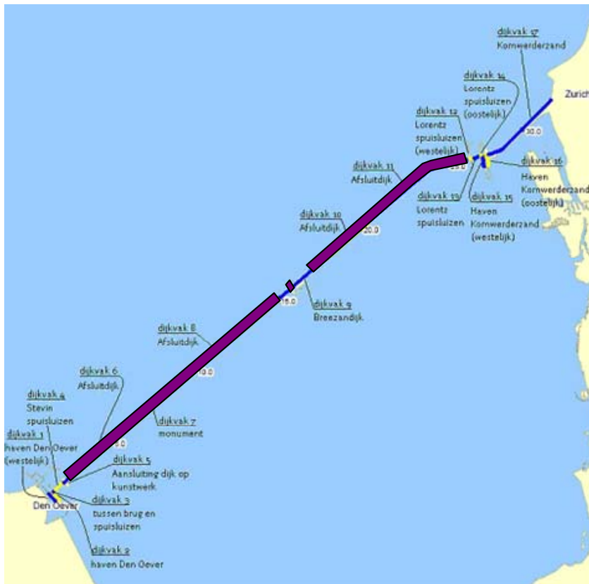
Figuur 3.1: Dijkvakken met representatief DWP Afsluitdijk
