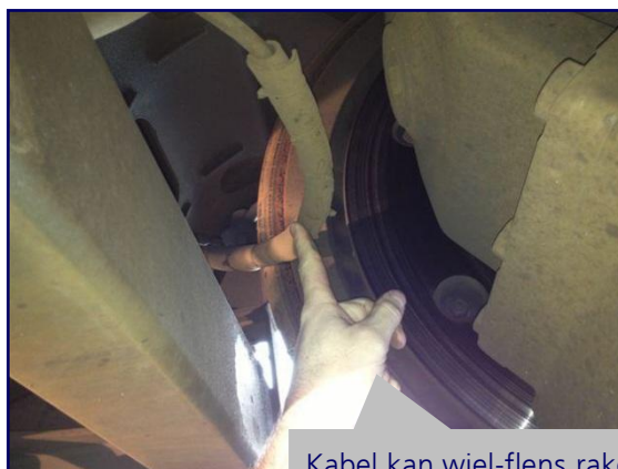
Kabel kan wiel-flens raken
