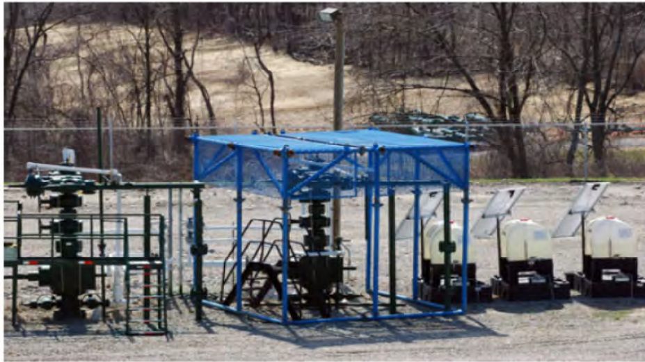
Afbeelding 2.7. Putmonden op een multi-well productie locatie [ref. 2.]
