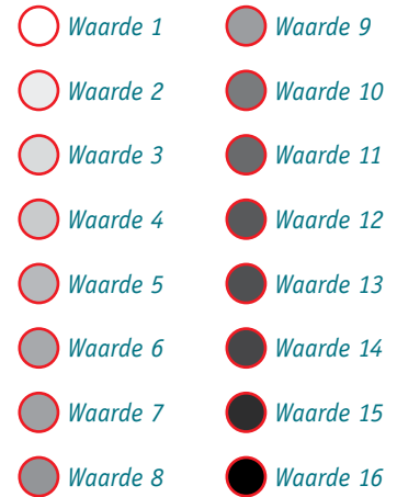
Afbeelding 2.1 Voorafgaand aan het scannen wordt een OMR-apparaat gekalibreerd, waarbij ingesteld wordt welke waarde tussen 1 (wit) en 16 (zwart) als '0' en welke als '1' moet worden weggeschreven.
