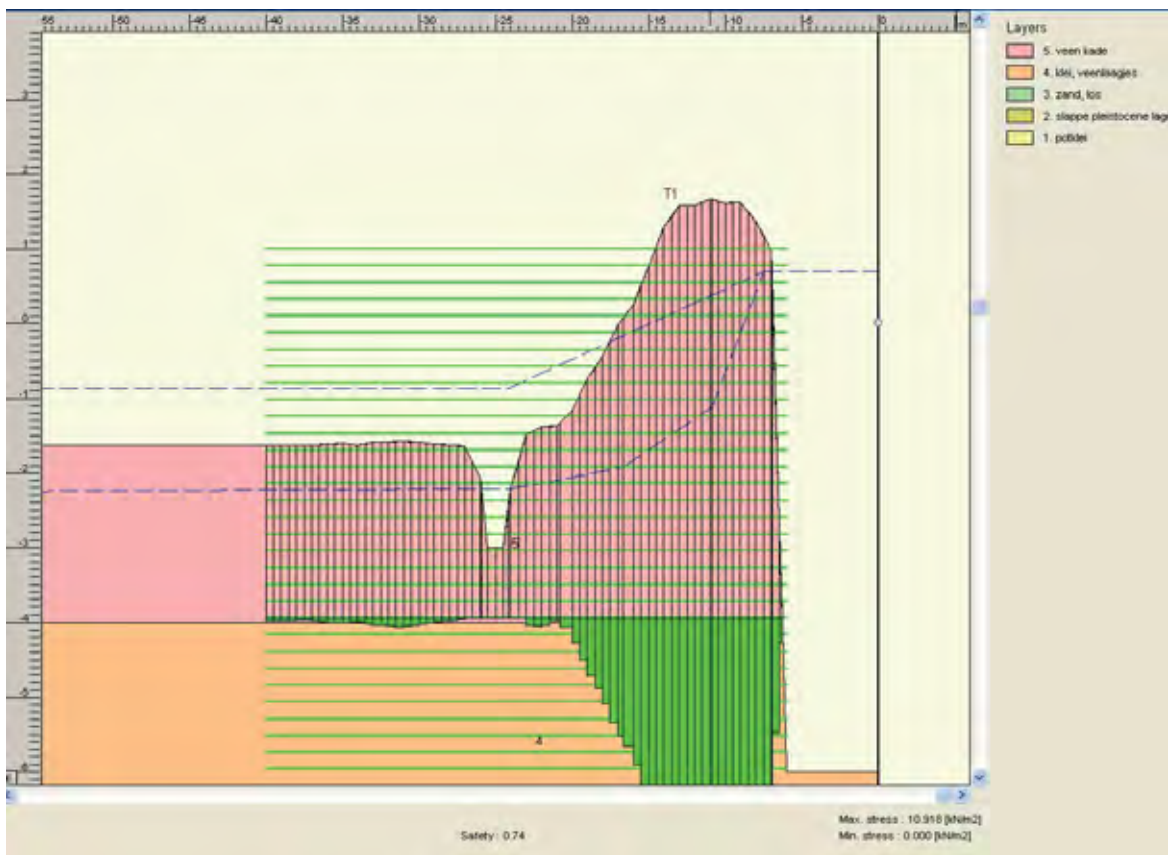
Figuur 4.14 Veenkade onder droge omstandigheden (reductie volumiek gewicht boven freatisch vlak), laag freatisch vlak
