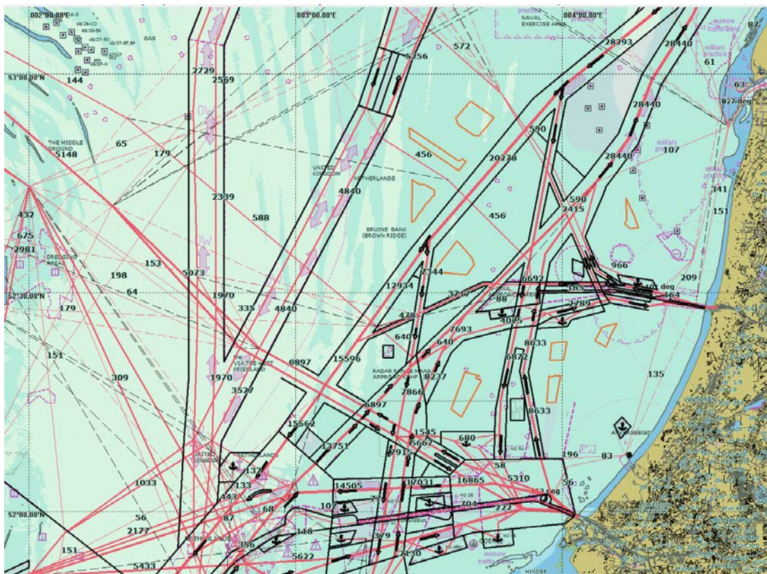
Figuur 5-5 T0-situatie: Verkeersafwikkeling vanaf augustus 2013 op basis van scheepsbewegingen in 2008. De oranje gebieden zijn de vergunde windparken
