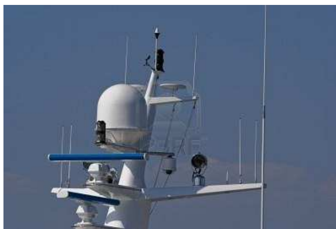
Figuur 74. Typische scheepsmast met radarantennes en communicatieantennes
