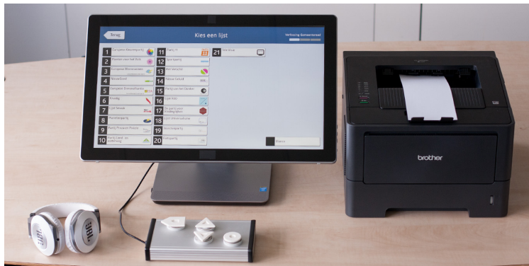
Figuur 23 Proefopstelling: koptelefoon, aanraakscherm, printer en tactiele knoppen.
