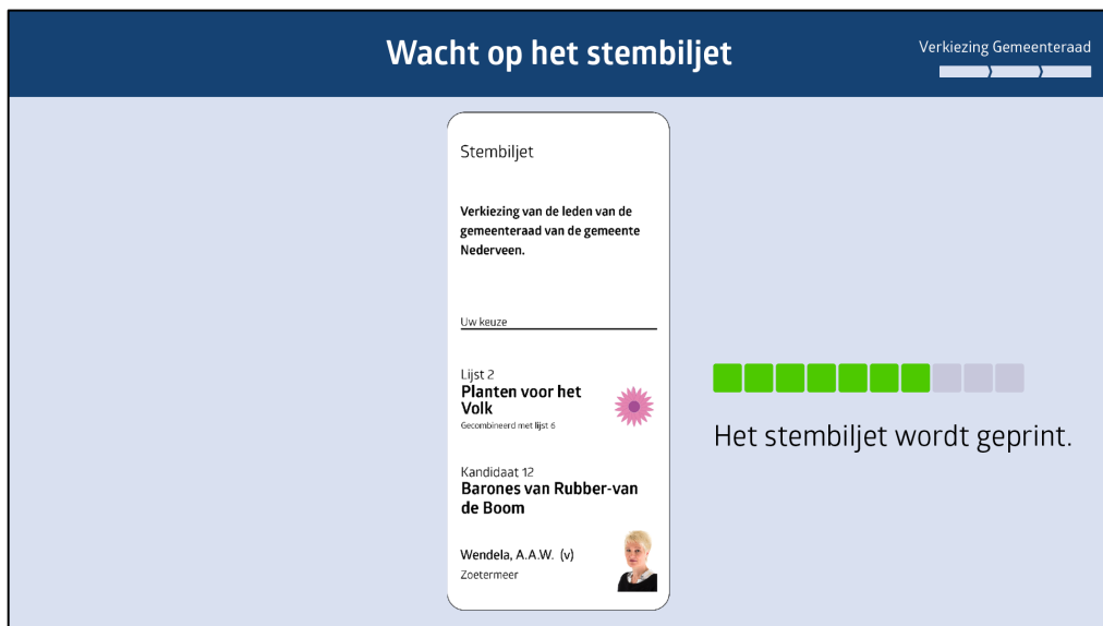
Figuur 12 Het scherm tijdens het printen van een stembiljet. Groene blokjes geven de voortgang aan.
