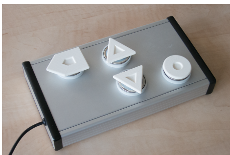
Figuur 20 Tactiele knoppen voor het bedienen van interactie 3: tactiele knoppen.
