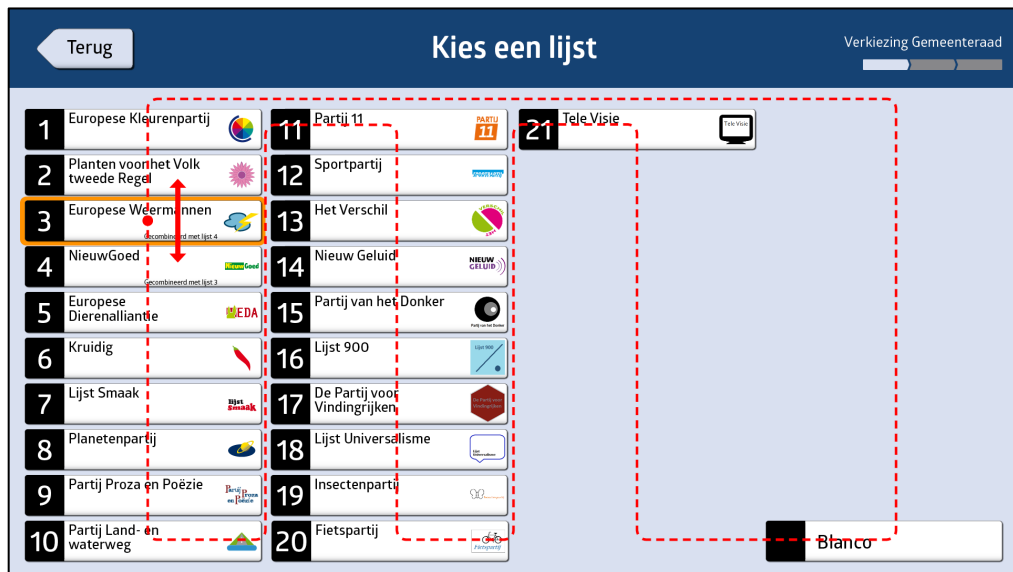
Figuur 19 Lijsten overzicht, de geselecteerde knop heeft een oranje rand. De rode gestippelde rode lijn geeft het pad aan wat gevolgd wordt. Deze is niet te zien voor de kiezer. Het pad kan via beide richtingen worden doorlopen.
