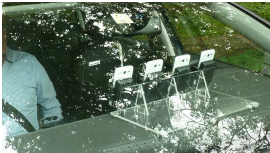
Figuur 3-2: Opstelling van de vier mobiele toestellen in de testauto (bron: AT)
