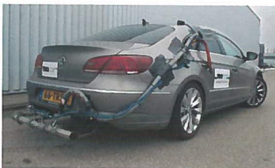
Een PEMS-systeem geïnstalleerd op een Euro 6 personenwagen.
