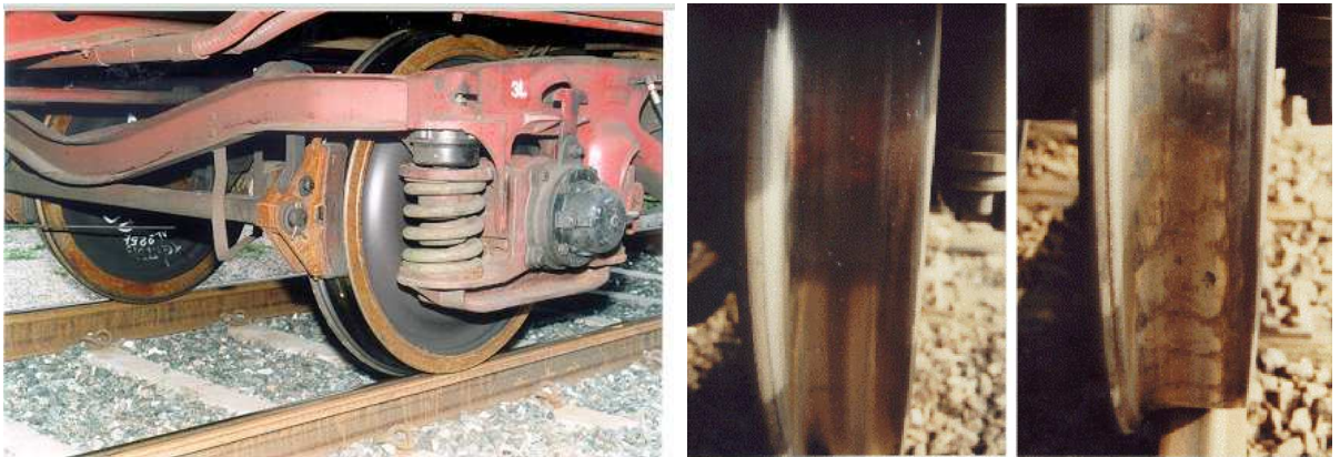
Figuur 4 Gietijzeren remblokken geven ruwere wielen en meer geluid. Inzet is op andere remsysteem wat leidt tot lagere geluidemissie spoor.
