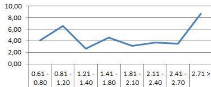
Figuur 1 – Gemiddeld aantal panelen dat nodig is om één EI-klasse omhoog te gaan - Meergezinswoningen
