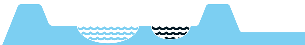
Rivierverruiming - in plaats van dijkversterking
