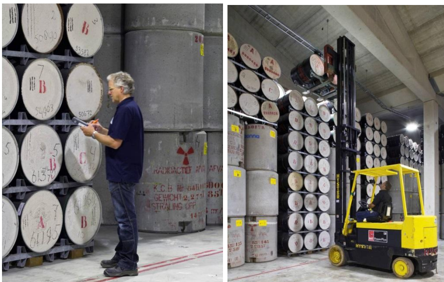
Figuur D.5 Laag- en middelradioactief afval opgeslagen in het LOG.
