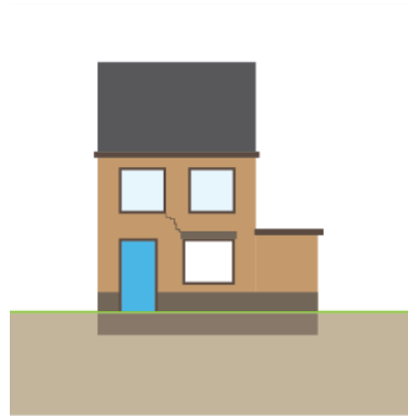
Afbeelding 3.19 Schadebeeld ontbreken dilataties in een metselwerk buitenwand
