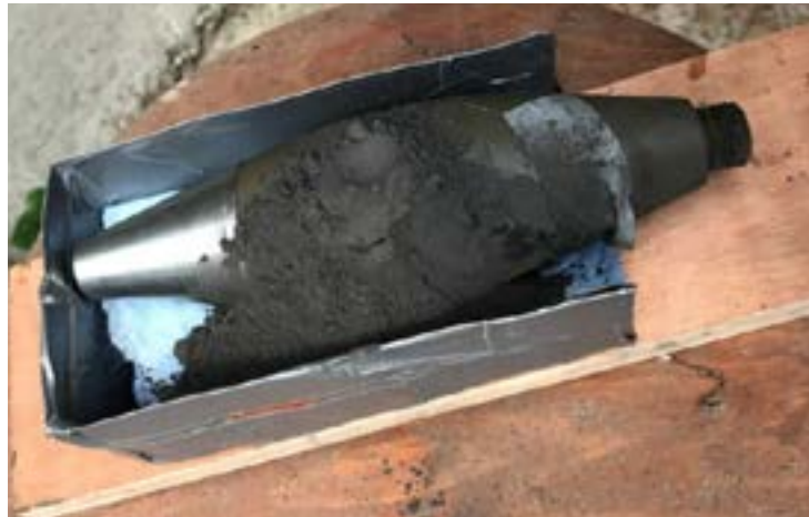
Figuur 20 Mortiergranaat met exudaat, bedekt met een thermietlading.
