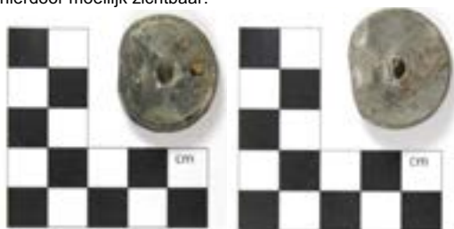
Figuur 1 Onderzijde (links) en bovenzijde (rechts) van de afsluitplaat afkomstig uit de M6-N schokbuis.
