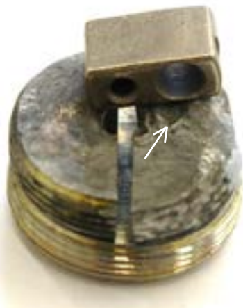
Figuur 10 Afsluiter van een referentie schokbuis geplaatst op de vervormde afsluitplaat en een afsluitplaat uit een referentie schokbuis.
