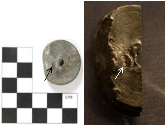
Figuur 9 Detail aan bovenzijde afsluitplaat (links: zoals gevonden, rechts: na doorzagen).
