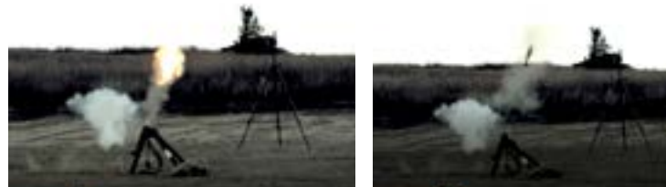
Figuur 23 Vlammen en hete gassen bewegen tot voorbij de mortiergranaat (foto links t=0 s) en komen uit de schietbuis, voordat de granaat de schietbuis verlaat (foto rechts t=1 s) [3].
