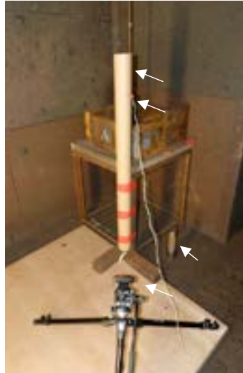
Figuur 9 Testopstelling met mechanische initiatie. Een valgewicht van ongeveer 1,7 kg valt na verwijderen van de veiligheidspin door een koker op de slaggpin.
