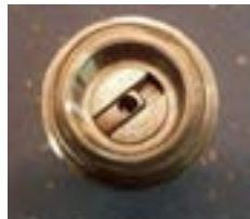
Figuur 4 M6-N schokbuis met sluiters in gewapende stand.
