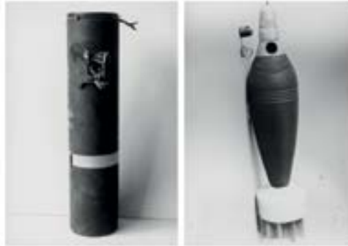
Figuur 12 Geperforeerde verpakking en verschoten rotor van de baanveiligheid van de 81 mm mortier [Josseling de Jong, 1976].
