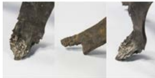
Figuur 18 Schadebeeld aan langwerpige delen onderste deel schietbuis.
