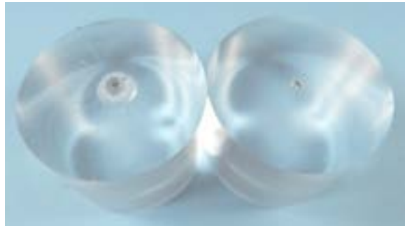
Figuur 23 Schade in PMMA cilinders als gevolg van ontsteken detcord met (links) en zonder (rechts) booster.
