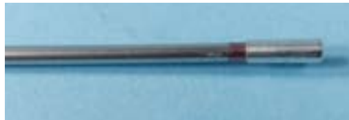
Figuur 5 Non-disruptive detonating cord (diameter 2,3 mm) met booster.
