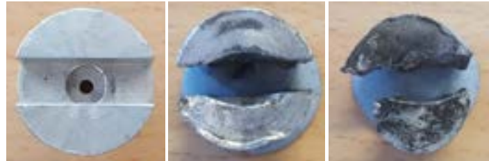
Figuur 9 Onderzijde van het huis ongebruikt (links), uit de test in gewapende stand (midden) en uit het ongeval (rechts).
