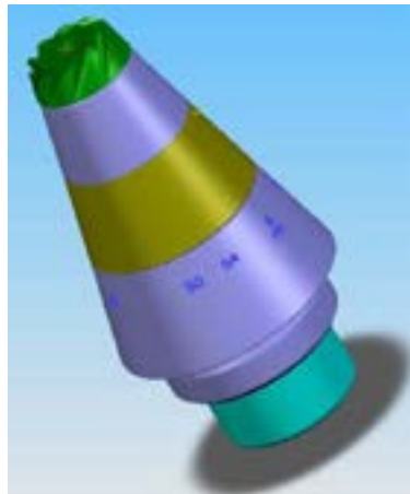
Figuur 28 Buis die slechts na het verkrijgen van snelheid in lucht een roterende beweging genereert, zie groene deel aan de bovenzijde van de buis met groeven geplaatst onder een hoek [8].
