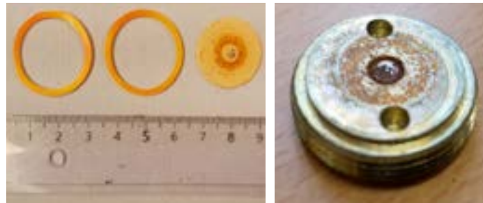
Figuur 26 Verkleuring van O-ringen en karton (links) en afzetting op de onderzijde van de afsluitplaat (rechts) in de M6-N schokbuis gebruikt bij de 70 °C doorslagtest.
