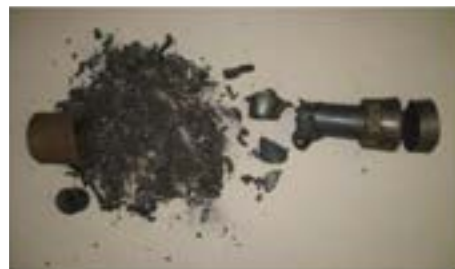
Figuur 20 Schadebeeld aan een afgesloten buis na een detonatie (links) en deflagratie (rechts).
