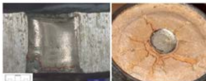
Figuur 20 Links: centrale gat van afsluitplaat van het ongeval met restant cupje overdrachtsslading [4]. Rechts: restant van de bodem van het cupje van de overdrachtsslading in de booster na experiment 5.
