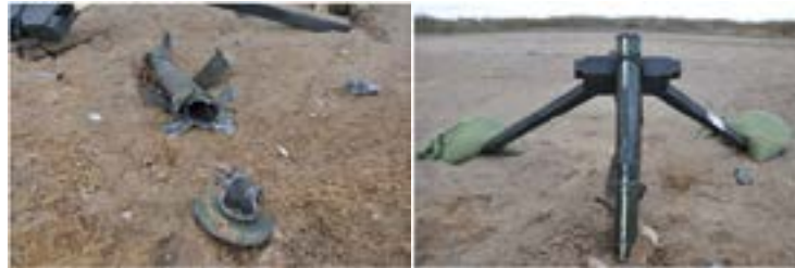
Figuur 21 Schietbuis na een inwendige detonatie (links) en deflagratie (rechts) van een 60 mm mortiergranaat [ref. 10].
