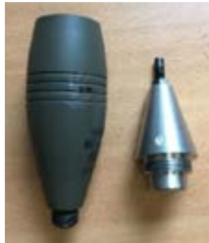
Figuur 18 HE80 mortiergranaat met aluminium dummy schokbuis.
