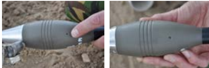
Figuur 24 Aangeboorde mortiergranaten met diameter 2 mm (links) en 5 mm (rechts) [2].
