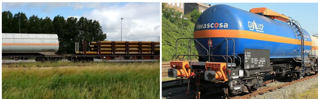
Figuur A: stalen pijpen achter een gevaarlijke stoffen wagon. Figuur B: voorbeeld overbufferingsbeveiliging (oranje) in combinatie met crashbuffers
