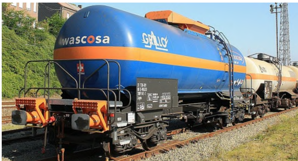
Figuur 2.2: Wagen met crashbuffer en opklimbeveiliging (oranje) op de buffer
