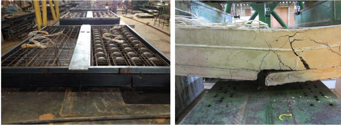
foto 13a en b vervaardiging proefstuk en respectievelijk een bezweken proefstuk [25]
