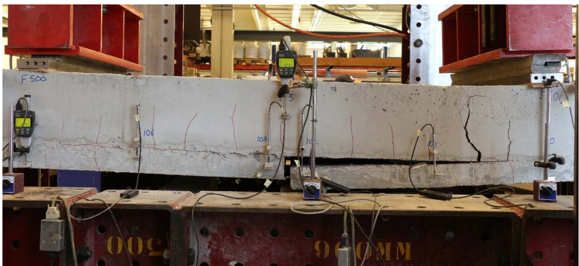
foto 18 Bezwijken door het door het onthechten van het aansluitvlak (proefstuk 24 - T2)
