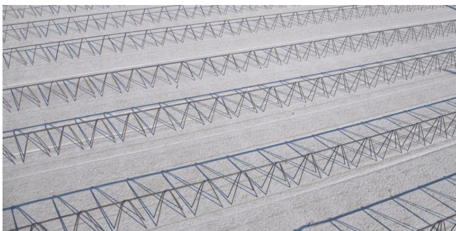
foto 1 Breedplaten na de productie (bron: https://www.cementonline.nl/stand-van-zaken-breedplaatvloeren )
