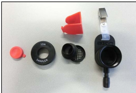
De IOM sampler in 'exploded view'. Van links naar rechts: afdekdop, schroefdeksel, filter bewaarhouder (boven), filtercassette (onder; in twee delen), en het samplerhuis met bevestigingsclip en tuit voor de luchtslang
