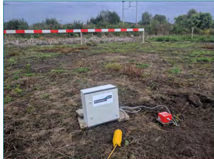
Afbeelding I.1 Trillingsmeter beperkt ingegraven
