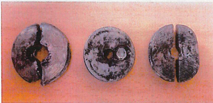
OVV-rapport figuur 14: Verschillende aanzichten van de bovenzijde van een afsluitplaat. Links de bovenzijde van de afsluitplaat uit de test in gewapende stand, in het midden een afsluitplaat uit de test in ongewapende stand en rechts de afsluitplaat uit het ongeval. De afsluitplaat uit de ongevalsgranaat is intact teruggevonden, maar is doorgezaagd voor nader onderzoek. (Foto TNO)
