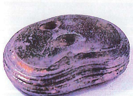
OVV-rapport figuur 26: Uitvergroting van de afsluitplaat afkomstig van de Ongevalsgranaat. (Foto: TNO)
