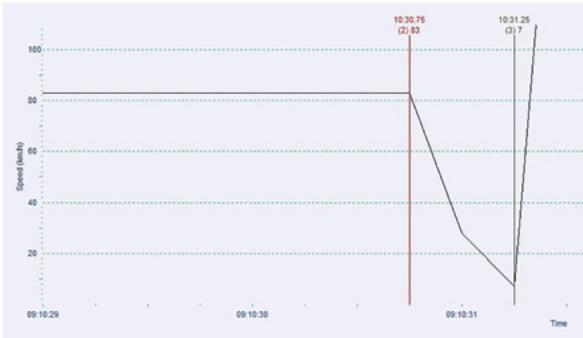
Figuur 18: Snelheidsregistratie afkomstig uit de tachograaf van de vrachtwagen. (Bron: Proces verbaal opgemaakt door de politie)
