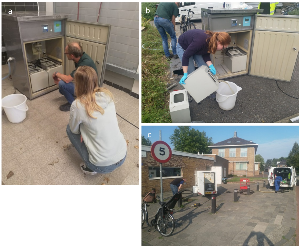
Figuur 2.2-1. Gebruikte monsternameapparatuur: vacuümkasten (a en b) en een meetwagen (c). In figuur a en b is de binnenkant van de vacuümkasten te zien met daarin 4 tanks waarin het afvalwater werd opgevangen en gekoeld bewaard. Na 48 uur bemonsteren werden de vaten geleegd en de monsters overgegoten in flessen en naar het lab getransporteerd.
