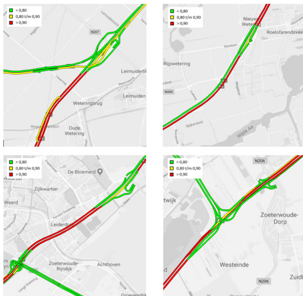
Figuur 3.4: I/C-verhoudingen referentiesituatie (2030) in de ochtendspits
