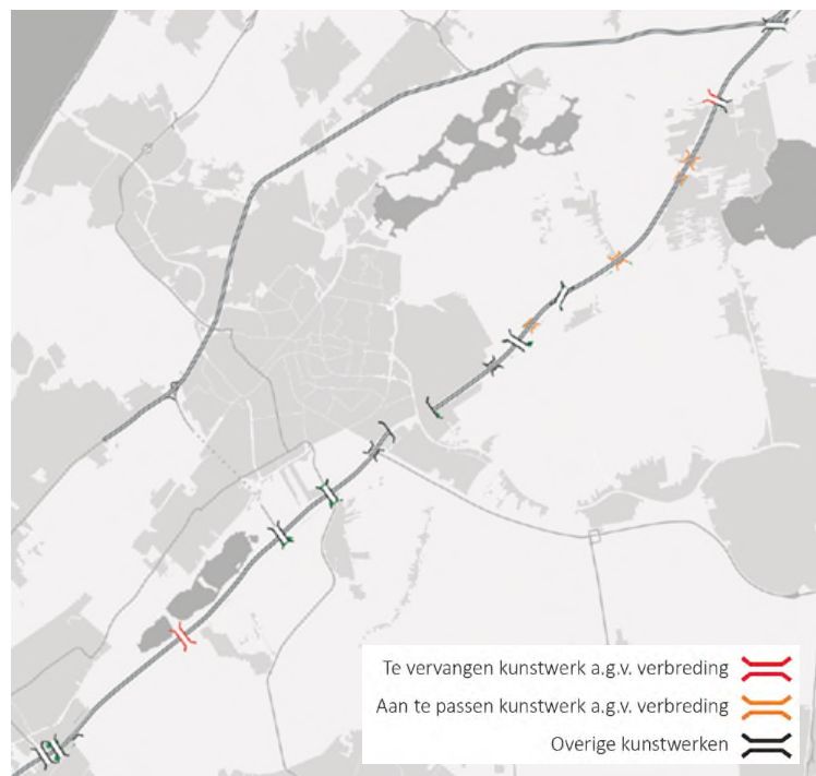
Figuur 10.4: Kunstwerken langs het tracé die aangepast worden ten behoeve van de alternatieven
