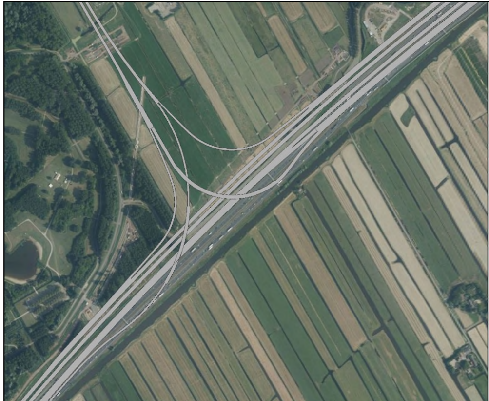
Figuur 5.1: Vormgeving van de rijbanen bij knooppunt Hofvliet met de verplaatsing van de weg van de A4
