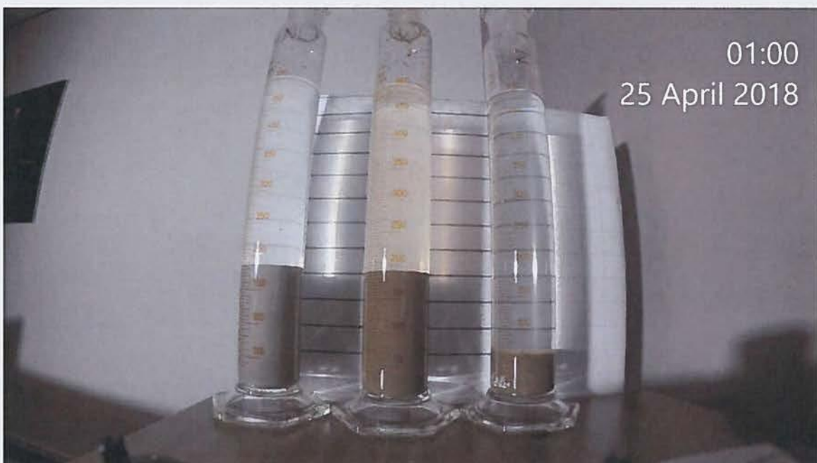
Figuur 4: Ongeveer 36 uur na het begin van bezinken. De helderheid van het water verandert bijna niet meer in de kolom met Noordse Leem en zand. De kolom met klei wordt in de volgende 13 uur (zie Figuur 5) iets helderder.
