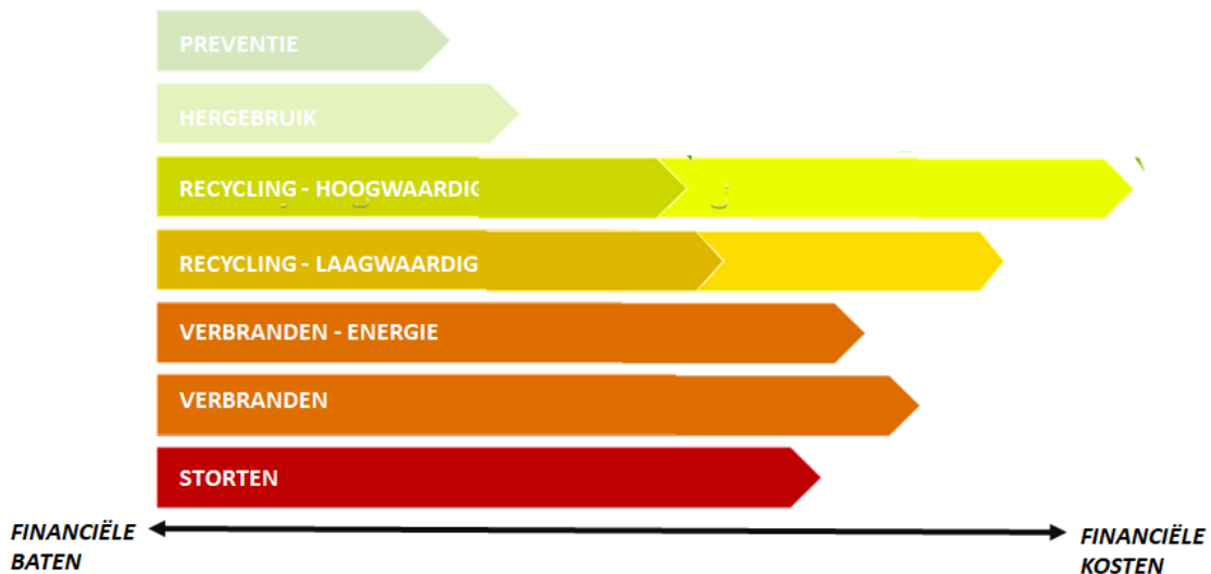
Figuur 9: “Omgekeerde afvalhiërarchie”: vaak liggen de financiële incentives omgekeerd aan de wenselijkheid (en juridische uitgangspunten) van de afvalhiërarchie. Merk op dat het schema slechts indicatief is, de lichtere banen beelden uit dat voor verschillende stromen en doelgroepen er een brede bandbreedte aan kosten/baten is.
