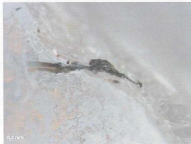
Figuur 5.2: Ruit 1. Insluitsel in het in figuur 5.1 afgebeelde glasdeeltje
