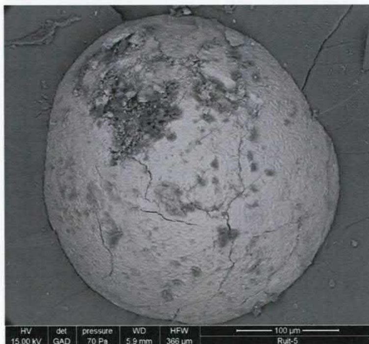
Figuur 5.20: Ruit 5. SEM opname van het insluitel op het centrale breukvlak van het vlinderpatroon. EDS analyse laat zien dat het om NiS gaat
