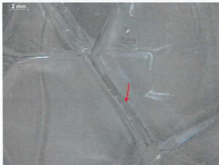
Figuur 5.9: Ruit 5. Stereomicroscopische foto van het centrale breukvlak in het vlinderpatroon met de locatie van het inluisel
