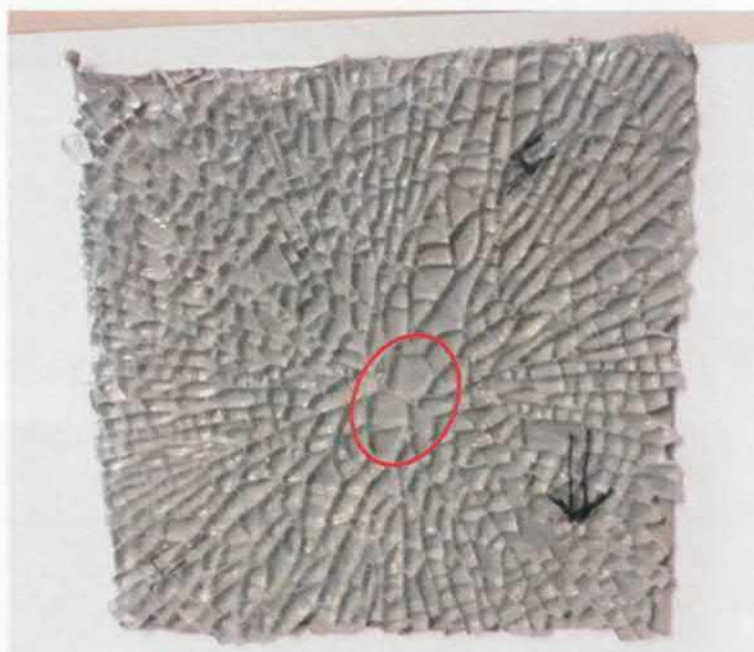
Figuur 5.4: Ruit 4. Vlinderpatroon centraal in het monster
