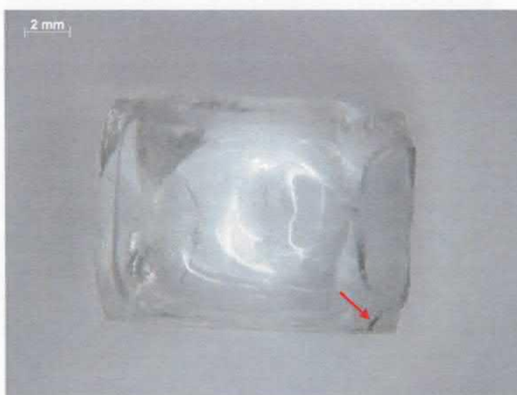
Figuur 5.1: Ruit 1. Overzicht van het geselecteerde glasdeeltje. De rode pijl geeft het insluitel aan
