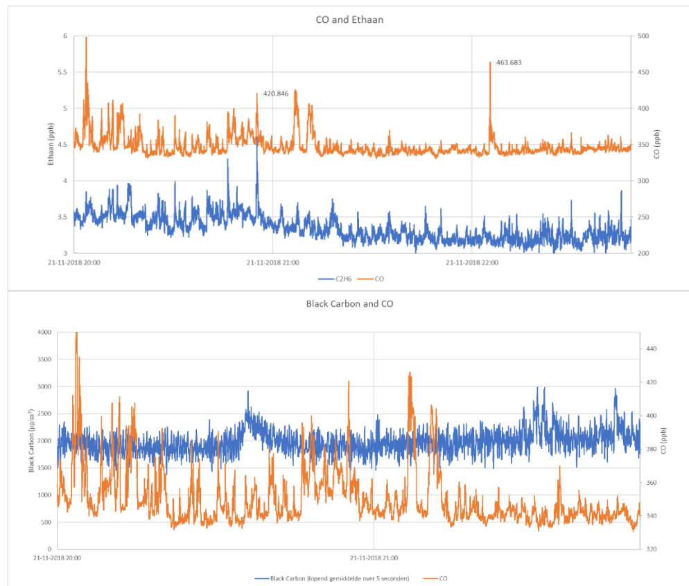
Figuur 14: Metingen op een parkeerplaats nabij Groet gedurende een periode waarin grote kans op 'houtstook' is (bovenste figuur van 20.00u-23.00u; onderste figuur van 20.00u-22.00u). Blauwe lijnen geprojecteerd op linker-as; oranje lijnen geprojecteerd op rechter-as.
