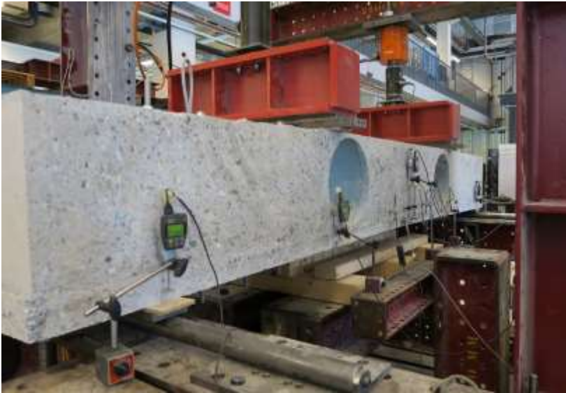
Foto 1. Uitgevoerde 4-punts-buigtest (2017) volgens het schema in Figuur 1
