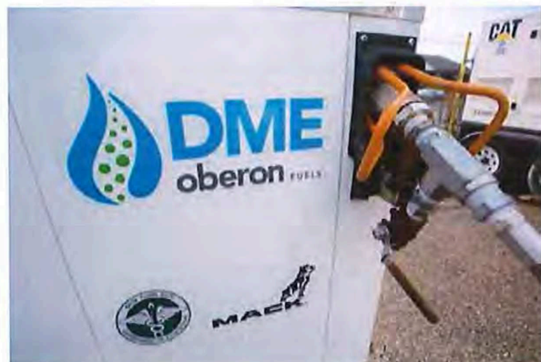
Figuur 6 Tankslang koppeling zoals gebruikt door Volvo in het BioDME project (linkerplaatje) en door Oberon (rechterplaatje).
