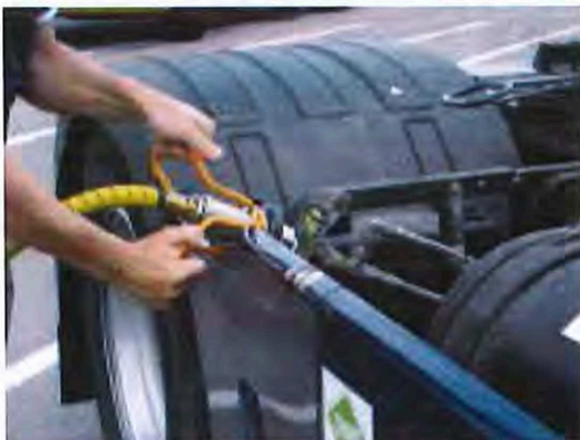
Figuur 6 Tankslang koppeling zoals gebruikt door Volvo in het BioDME project (linkerplaatje) en door Oberon (rechterplaatje).
