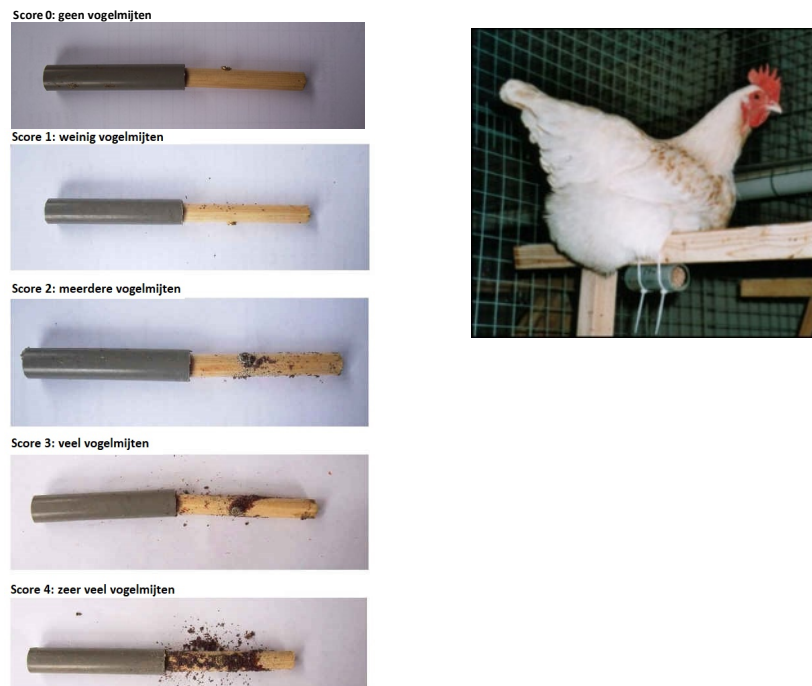
Figuur 3.3 Rickstick (wekelijks controleren van de vallen, registreren, schoonmaken met kwast van stokje en binnenkant pvc buis) (Foto: Rick van Emous, WLR).
