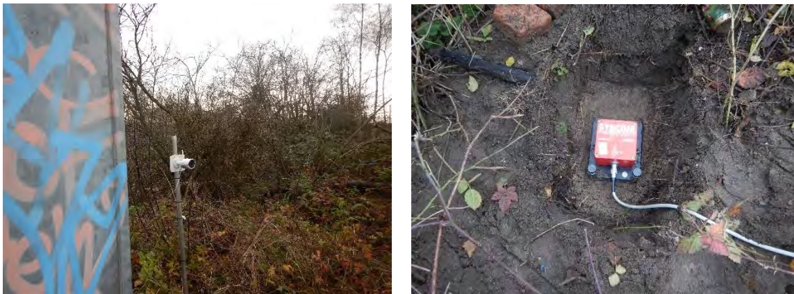
Afbeelding I.1 Onderdelen van de meetopstelling: camera en Syscom MR3000C-meetsysteem
